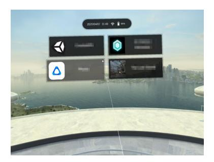
キオスクモードを終了するには、ヘッドセットの電源ボタンを長押しし、**キオスクモードを終了**を選択して、パスコードを入力します(有効にしている場合)。
